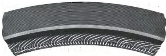
Schuppenförmige Schleifenwicklung der E. A. G. Lahmeyer.
